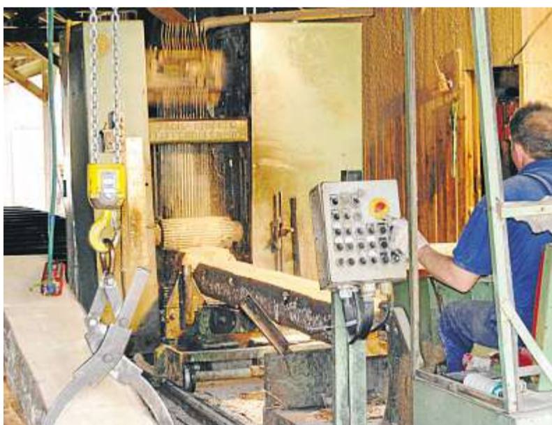
Durchs Sägegatter müssen die Stämme, die Sägewerks-Arbeiter Anton Bierl vorschleibt, in Minutenschnelle.
