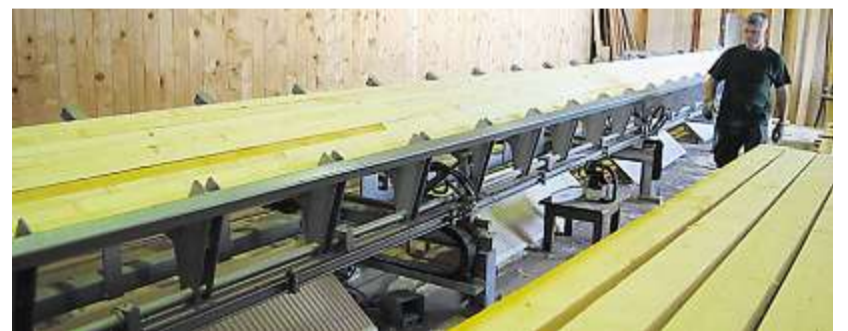
Eine einzigartige Maschine macht den Bau der Holzwände per Holzdübel, ohne Nägel und Leim, möglich.
