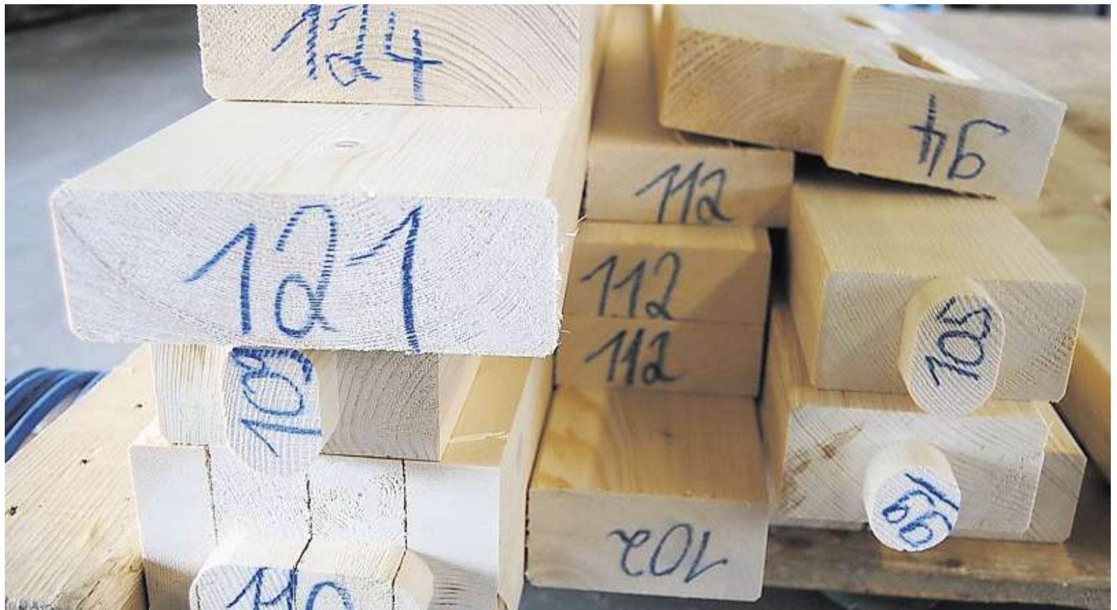
Nach Nummern geordnet werden die Teile des Teredo-Holzhauses später auf der Baustelle zusammengesetzt. Die großen Wände, die in Waldmünchen zusammengebaut werden, sind in Längssegmente aufgeteilt. Das bringt laut Josef Karl Stabilität und das richtige Holzhaus-Aussehen. Fotos: Klöckner
